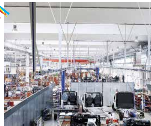
▲ Produktionslinan är mer automatiserad än vi är vana att se. Monteringen är manuell, men materialhanteringen är automatiserad. Produktionschefen var glad att äntligen kunna bygga husbilar enligt "batch one". Med det menas att man inte behöver bygga serier om 5, 10 eller 20 bilar av samma modell för att få en rationell produktion, nu är det serier om en bil i taget – batch one.
