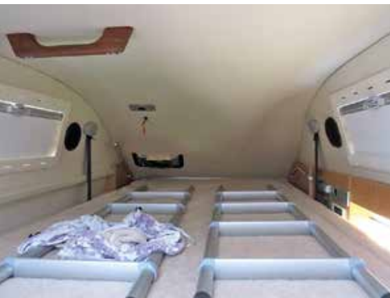
▲ Sängen är takhängd och körs ner ned elektriskt
