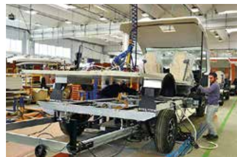
▲ Golvet lyfts på i ett stycke. Innan man lyfter dit det har man lagt en sträng sikaflex på alla ytor på chassit som har kontakt med golvet. Det inte bara har en limmande effekt, det hindrar även att oljud uppstår. Till sist bultas golv och chassi ihop med grova vagnsbultar.
