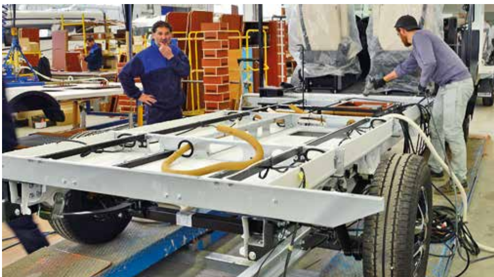
▲ Den extra ramen blir ett så kallat tekniskt dubbelgolv i vilket värmeslangar, elkablar och slangar kan dras.
