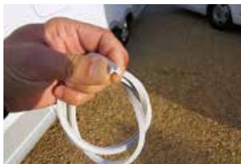
▲ Genom att nypa listan "rakt över ryggen" så öppnar den sig
