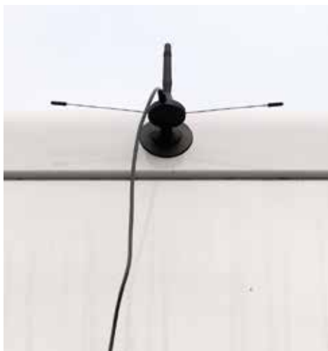
▲ En extern antenn för att bättre fånga upp 3/4G signaler gör stor skillnad. Antennhöjd är inte sällan avgörande för god mottagning.
