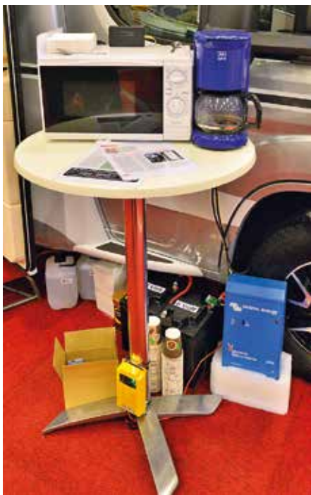
◀ För att visa det förträffliga med dubbla 6 volts batterier använde vi dem för att via en inverter koka kaffe och microvärma bullar.
