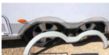
▲ Skärmen demonterad för listbyte
