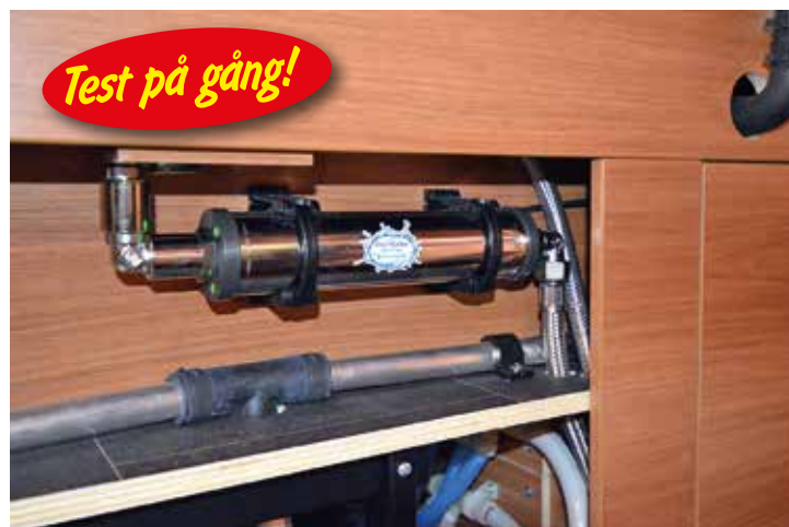
▲ En vattenreningsutrustning med LED UV-ljus. Vi testar den just nu.
